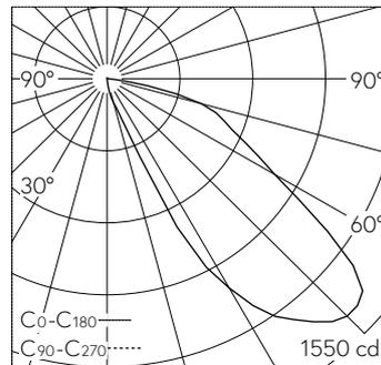
LED 3000 K 14 W 1207 lm-h / CIE Flux 25 71 94 100 100 / A20 selon DIN 5040
