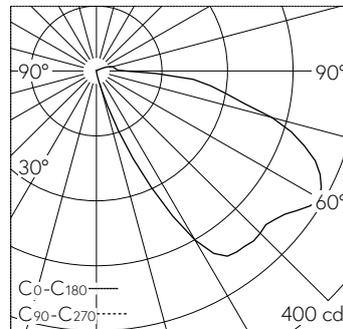
LED 4000 K 4 W 471 lm-h / CIE Flux 18 51 83 96 100 / A11 selon DIN 5040
