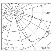
LED 4000 K 6.4 W 691 lm-h / CIE Flux 20 54 86 96 100 / A11 selon DIN 5040
