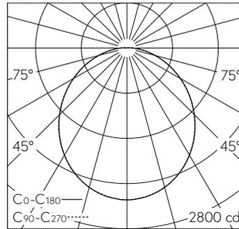
LED 3000 K 52.6 W 6519 lm-h / CIE Flux 47 78 94 99 100 / A40 selon DIN 5040
