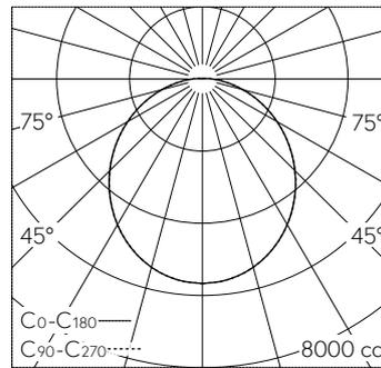
LED 3000 K 121.2 W 16141 lm-h / CIE Flux 47 77 93 99 100 / A40 selon DIN 5040
