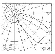
LED 4000 K 6.7 W 119 lm-h / CIE Flux 15 55 86 99 100 / A10 selon DIN 5040
