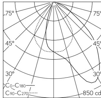
LED 3000 K 10 W 708 lm-h / CIE Flux 74 97 100 100 100 / A70 selon DIN 5040
