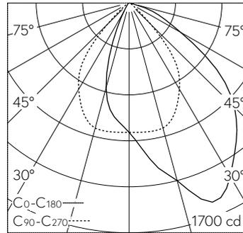
LED 4000 K 19.6 W 1663 lm-h / CIE Flux 71 96 100 100 100 / A60 selon DIN 5040
