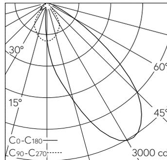
LED 4000 K 18.3 W 2042 lm-h / CIE Flux 66 95 99 100 100 / A60 selon DIN 5040
