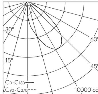
LED 4000 K 35.6 W 4151 lm-h / CIE Flux 64 95 100 100 100 / A60 selon DIN 5040
