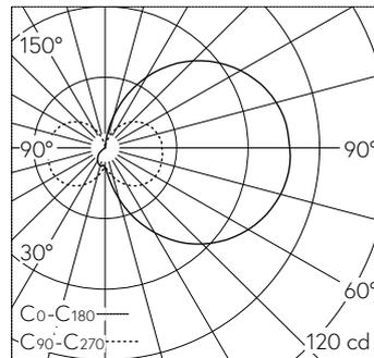
LED 4000 K 4 W 320 lm-h / CIE Flux 17 42 69 53 100 / C11 selon DIN 5040
