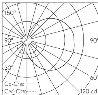
LED 3000 K 3.8 W 266 lm-h / CIE Flux 25 51 76 60 100 / B11 selon DIN 5040
