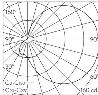
LED 3000 K 6.8 W 613 lm-h / CIE Flux 24 51 75 59 100 / C11 selon DIN 5040
