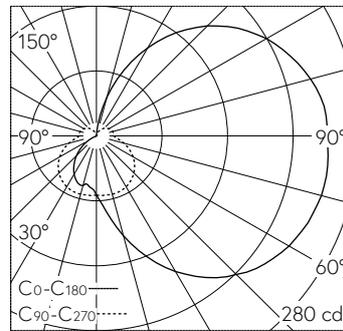
LED 4000 K 9.7 W 863 lm-h / CIE Flux 24 51 75 59 100 / C11 selon DIN 5040
