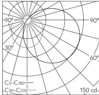
LED 3000 K 5 W 320 lm-h / CIE Flux 29 55 78 76 100 / B21 selon DIN 5040
