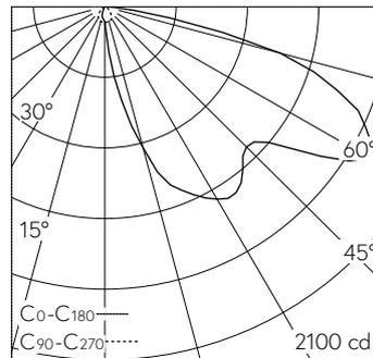
LED 4000 K 16 W 1866 lm-h / CIE Flux 32 65 94 100 100 / A20 selon DIN 5040
