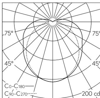
LED 4000 K 7.1 W 557 lm-h / CIE Flux 40 68 87 90 100 / A31 selon DIN 5040
