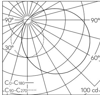
LED 3000 K 5.1 W 226 lm-h / CIE Flux 33 59 81 82 100 / B21 selon DIN 5040
