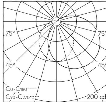
LED 3000 K 7.8 W 399 lm-h / CIE Flux 39 66 85 87 100 / B31 selon DIN 5040
