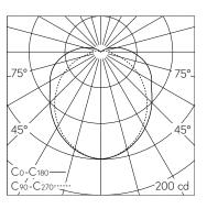
LED 3000 K 7.1 W 515 lm-h / CIE Flux 41 69 87 91 100 / A31 selon DIN 5040
