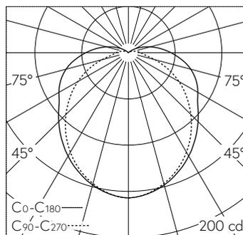
LED 4000 K 7.1 W 541 lm-h / CIE Flux 41 69 87 91 100 / A31 selon DIN 5040
