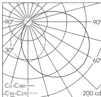
LED 3000 K 7.8 W 423 lm-h / CIE Flux 34 61 82 82 100 / B21 selon DIN 5040
