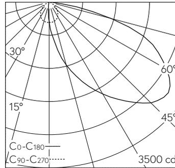
LED 4000 K 36 W 4363 lm-h / CIE Flux 28 66 94 100 100 / A20 selon DIN 5040
