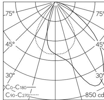
LED 4000 K 10 W 741 lm-h / CIE Flux 71 95 100 100 100 / A60 selon DIN 5040
