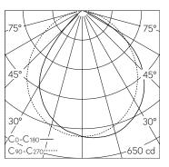
LED 4000 K 14.5 W 1323 lm-h / CIE Flux 59 89 99 100 100 / A50 selon DIN 5040
