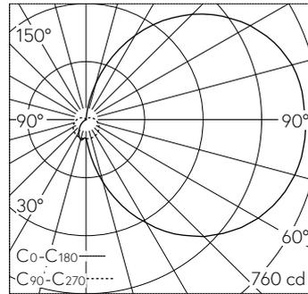
LED 3000 K 26.5 W 2360 lm-h / CIE Flux 18 43 70 55 100 / C11 selon DIN 5040
