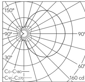
LED 3000 K 7 W 532 lm-h / CIE Flux 20 46 72 50 100 / C12 selon DIN 5040
