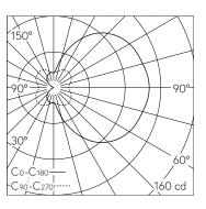
LED 4000 K 7 W 560 lm-h / CIE Flux 20 46 72 50 100 / C12 selon DIN 5040
