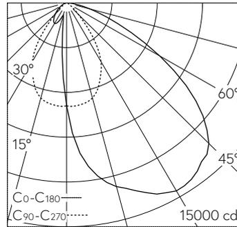
LED 3000 K 170 W 15496 lm-h / CIE Flux 59 89 98 100 100 / A50 selon DIN 5040
