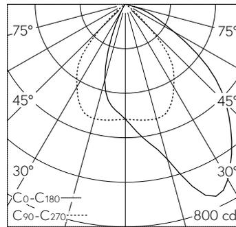
LED 4000 K 9.2 W 763 lm-h / CIE Flux 70 96 100 100 100 / A60 selon DIN 5040
