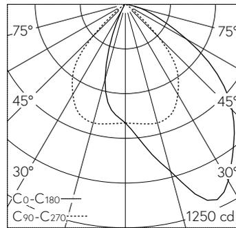
LED 3000 K 13.2 W 1316 lm-h / CIE Flux 67 94 100 100 100 / A60 selon DIN 5040
