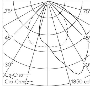
LED 3000 K 19.3 W 1932 lm-h / CIE Flux 66 93 100 100 100 / A60 selon DIN 5040
