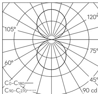
LED 3000 K 4.9 W 281 lm-h / CIE Flux 47 79 96 50 100 / C43 selon DIN 5040
