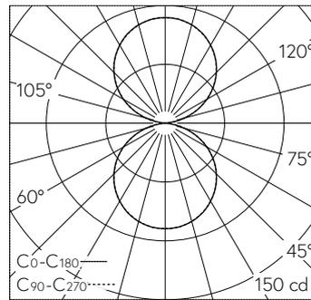
LED 3000 K 6.8 W 501 lm-h / CIE Flux 47 79 96 50 100 / C43 selon DIN 5040
