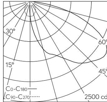
LED 3000 K 18.8 W 2576 lm-h / CIE Flux 37 74 96 100 100 / A30 selon DIN 5040
