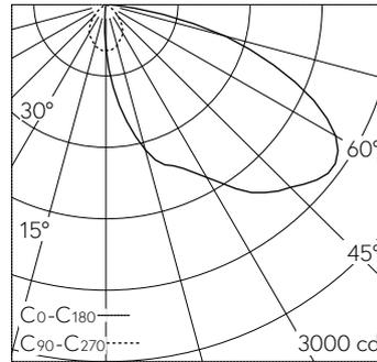
LED 4000 K 18.8 W 2649 lm-h / CIE Flux 37 74 96 100 100 / A30 selon DIN 5040
