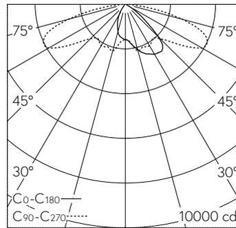
LED 4000 K 67 W 9422 lm-h / CIE Flux 34 66 93 100 100 / A20 selon DIN 5040
