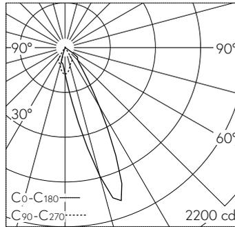
LED 4000 K 5.1 W 366 lm-h / CIE Flux 88 100 100 100 100 / A80 selon DIN 5040
