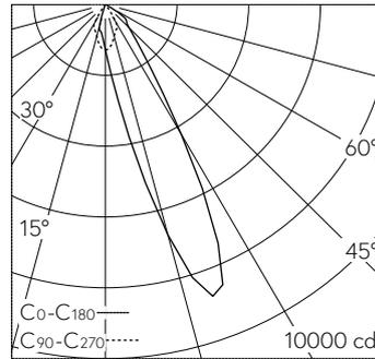
LED 3000 K 24.8 W 2021 lm-h / CIE Flux 86 100 100 100 100 / A80 selon DIN 5040
