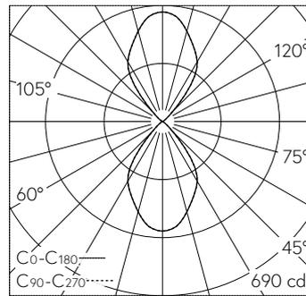
LED 3000 K 9 W 973 lm-h / CIE Flux 89 99 100 50 100 / C84 selon DIN 5040
