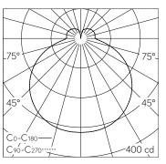
LED 3000 K 12.5 W 1450 lm-h / CIE Flux 40 70 89 79 100 / B32 selon DIN 5040
