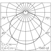
LED 4000 K 38.5 W 4762 lm-h / CIE Flux 43 74 92 88 100 / B31 selon DIN 5040
