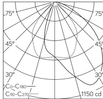
LED 4000 K 13.2 W 1245 lm-h / CIE Flux 66 93 99 100 100 / A60 selon DIN 5040
