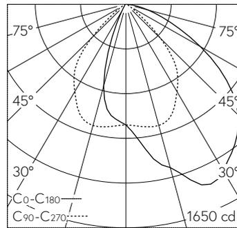
LED 3000 K 19.6 W 1902 lm-h / CIE Flux 60 88 97 100 100 / A50 selon DIN 5040
