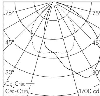
LED 4000 K 19.6 W 1949 lm-h / CIE Flux 60 88 97 100 100 / A50 selon DIN 5040
