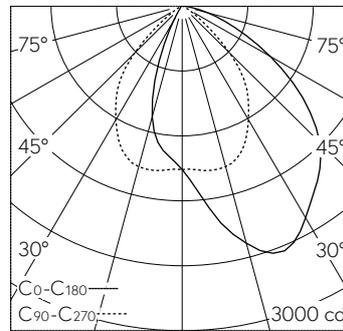
LED 3000 K 27.1 W 3004 lm-h / CIE Flux 64 91 99 100 100 / A60 selon DIN 5040
