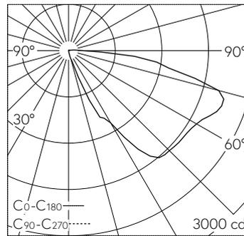
LED 4000 K 22.7 W 2098 lm-h / CIE Flux 17 51 82 99 100 / A10 selon DIN 5040
