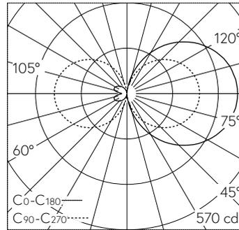
LED 4000 K 27 W 2680 lm-h / CIE Flux 13 37 66 50 100 / C11 selon DIN 5040
