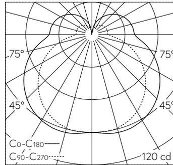
LED 3000 K 7.4 W 558 lm-h / CIE Flux 34 63 84 72 100 / B21 selon DIN 5040
