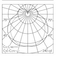
LED 3000 K 14.8 W 1106 lm-h / CIE Flux 36 65 86 75 100 / B31 selon DIN 5040
